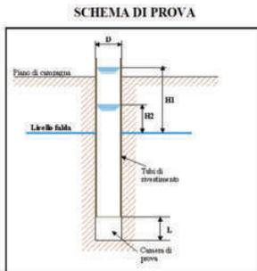
In caso di falda assente H1 e H2 sono riferiti alla profondità finale della camera di prova
